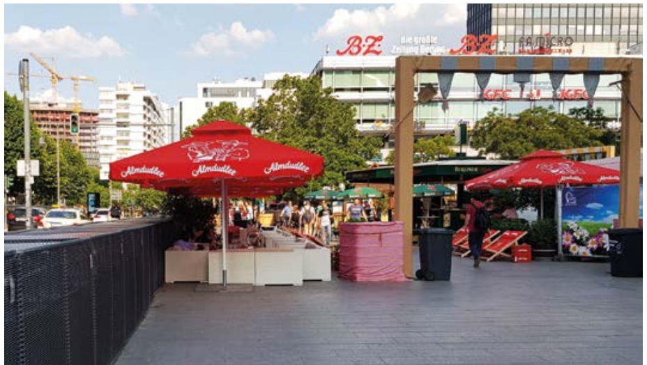
Abbildung 3: Breitscheidplatz/Budapester Straße, hier wurde eine Gastronomie direkt an die Fahrzeugsperranlage und Eindringtiefe des Fahrzeuges sowie Weite des Trümmerfluges und Ausbreitung des Splitterfeldes nicht berücksichtigt. © D. Schürmann
